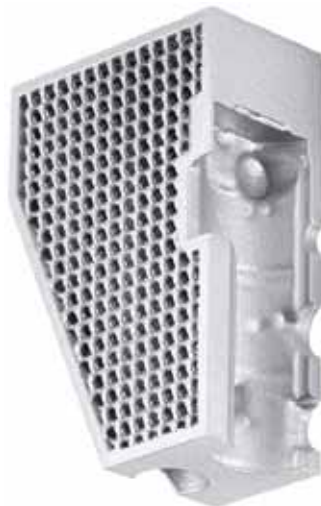
Bild 7: Technologievorteil durch Additive Manufacturing: Die eGRIP Metallfinger von Schunk verfügen über eine integrierte Hohl-gitterstruktur, die Gewichteinsparungen zwischen zehn und 50 Prozent ermöglicht
