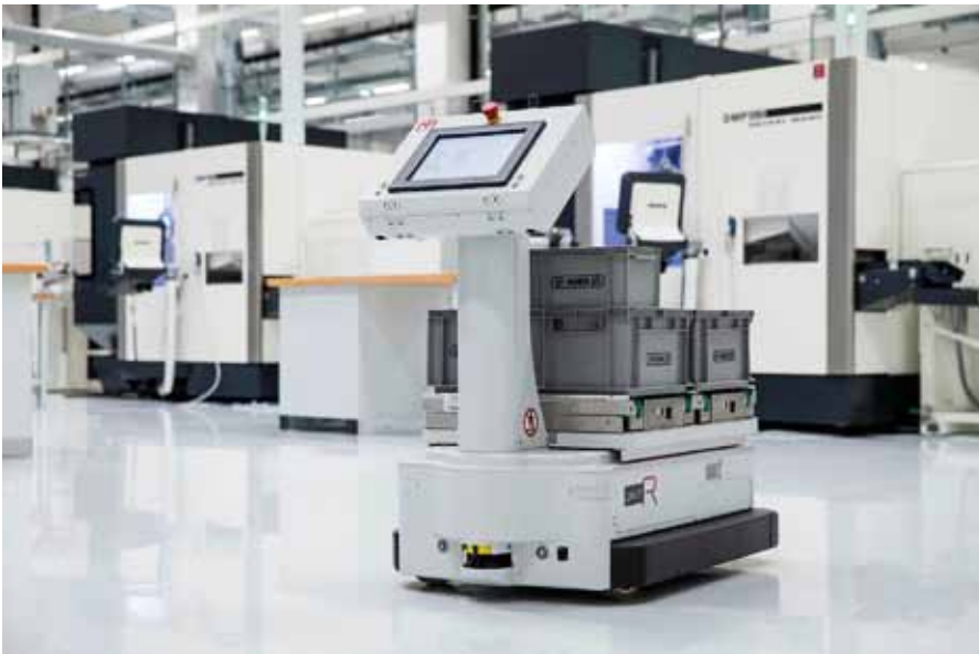
Bild 5: Fahrerloses Transportsystem für den Inhouse Werkstransport im Einsatz bei Präzisionswerkzeugehersteller Paul Horn
