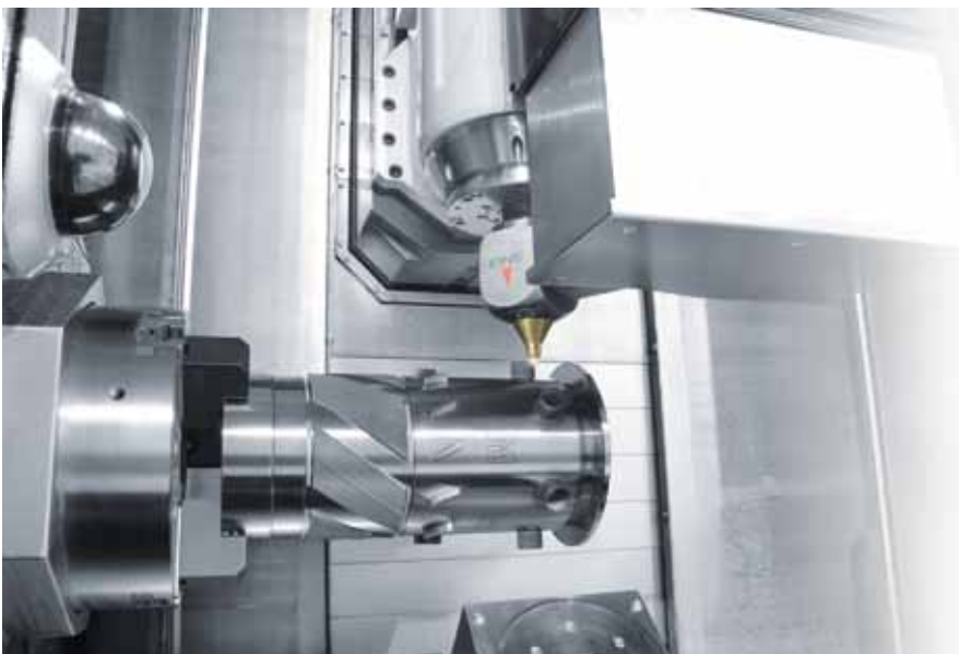
Bild 4: Multifunktionsmaschinen wie hier von Mazak erobern immer mehr den Markt der Werkzeugmaschinen: Sie integrieren verschiedene Bearbeitungstechnologien und bieten so höchste Vielseitigkeit und Leistungsfähigkeit (Werkbild: Mazak)
