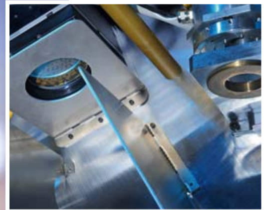
Oben: Mit dem integrierten Spiegel lässt sich der Laserstrahl mit Schaltzeiten von unter fünf Millisekunden an neue Bearbeitungssituationen anpassen.
