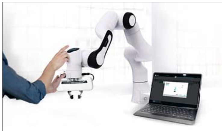
Der Leichtbau-Roboter Panda greift mit einer Kraft von 70 N und bewegt sich mit 30 mm pro Sekunde.
