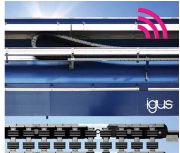
Neue wartungsfreie Gleitlager und ein intelligenter Verschleißsensor sorgen für eine höhere Lebensdauer in der P4.1 Rollenkette für Kran- und Portalanlagen. Bild: Igus
