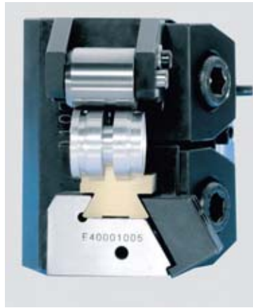
Links: Kalibrierhalter mit Gegenrolle und AWN20-Kalibrierer-Skiving-Werkzeug mit geneigter Plattenstellung, Rechts: Kalibrierhalter mit Gegenrolle und AWN20-Kalibrierer.
