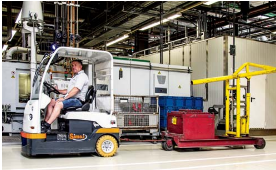
Im Einsatz: Der Elektroschlepper TTE71 versorgt die Werkshallen mit Ersatzteilen und zieht ein hydraulisches Hebehilfsmittel zur Instandhaltung der Maschinen.
