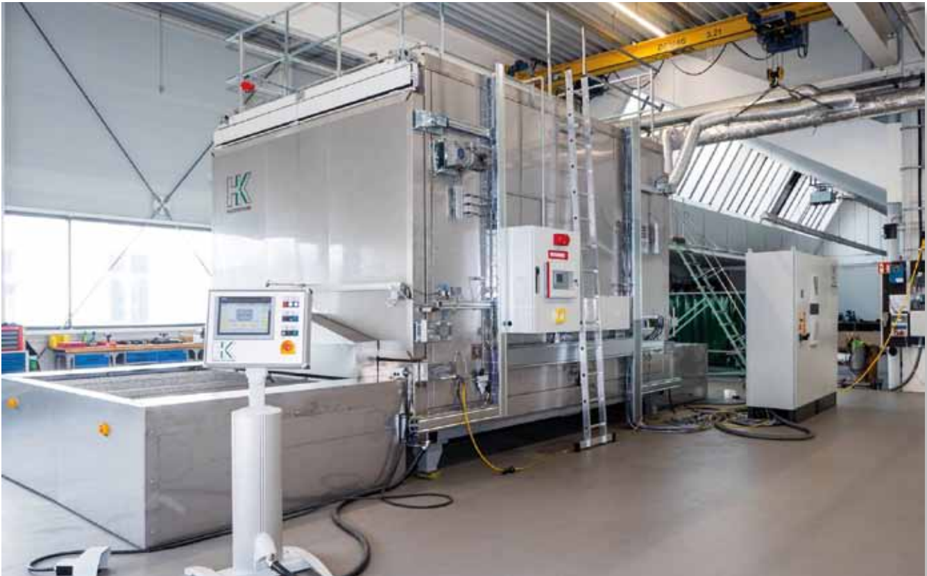
Bild 1: Für die Umformung von flächigen und vorgeformten Komposite-Halbzeugen zu Hochleistungs-Bauteilen erwärmen Umluftöfen thermoplastische Verbundwerkstoffe homogen, schonend und energiesparend
