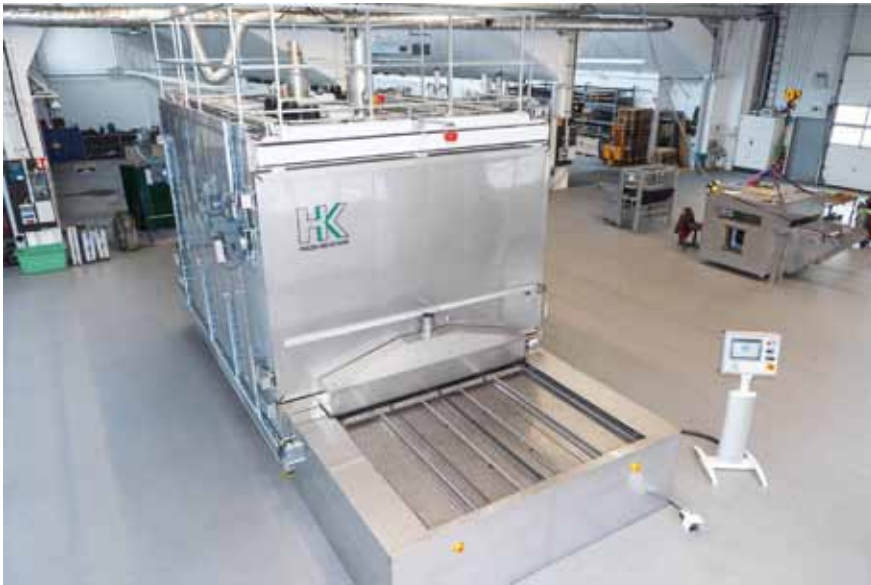
Bild 2: In den Umluftöfen werden je nach Bauhöhe des Teils bis zu 36 Aufnahmeroste, die wie Schubladen aussehen, durch zwei Kammern befördert, z.B. für Taktzeiten <= 30 sec., bei Materialstärken von ca. 3 mm
