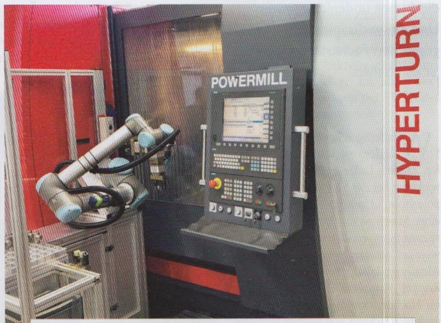
Das Ventilgehäuse wurde früher auf vier Maschinen mit ebenso vielen Aufspannungen bearbeitet. Heute fertigt ein Bearbeitungszentrum mit Haupt- und Gegenspindel das Werkstück in zwei Aufspannungen in einem Bruchteil der früheren Zeit. Und mit Beladeroboter läuft der gesamte Prozess vollautomatisch ab.
