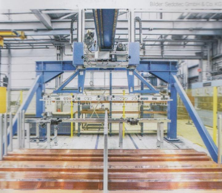
**Bild 2** | Das Gantry System ist der Kern der Automatisierung für die beiden autark arbeitenden Stanzmaschinen. Unter dem Portalkran gibt es zwei Lagerbereiche für je 40t Material unterschiedlicher Abmessungen.
