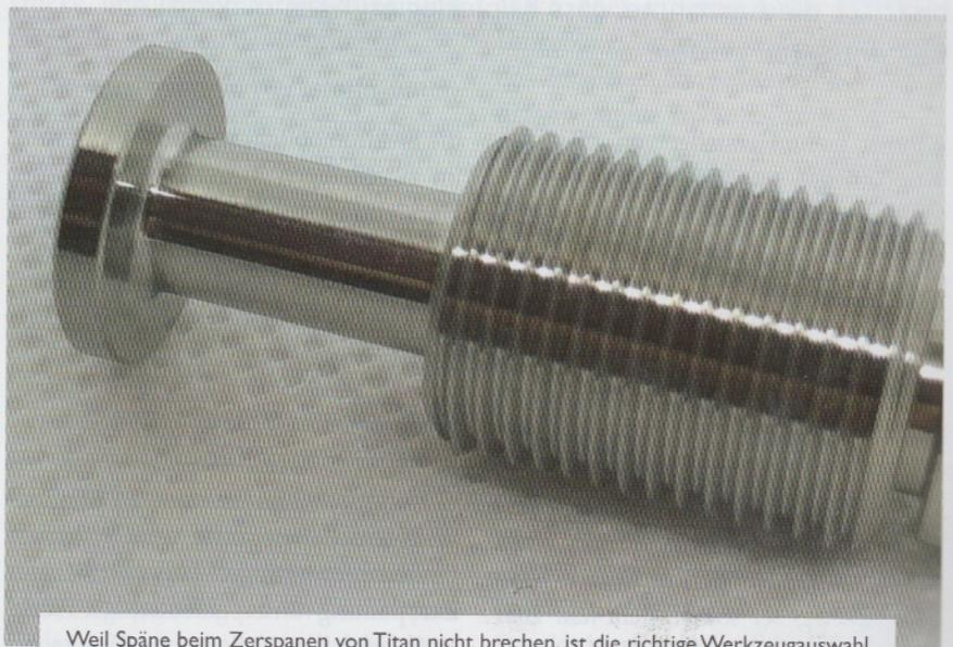
Weil Späne beim Zerspanen von Titan nicht brechen, ist die richtige Werkzeugauswahl fürs Gewindedrehen besonders wichtig.
