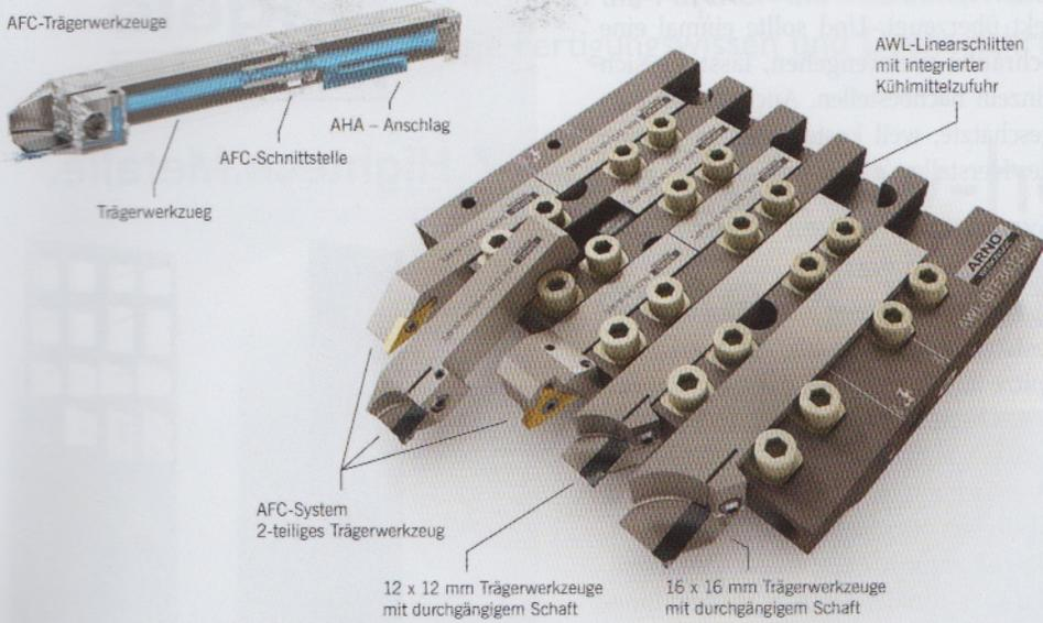
Das Besondere am AWL-Linearschlitten von ARNO ist die integrierte Kühlmittelzufuhr. Durch die Kühlkanäle kann Kühlmittel mit bis zu 150 bar Hochdruck gezielt auf den gewünschten Punkt der Schneide gebracht werden. Mit der internen KSS-Zufuhr entfällt das zeitaufwändige Anschließen einer externen Verschlauchung. Im Maschinenraum gibt es keine Störkonturen.
