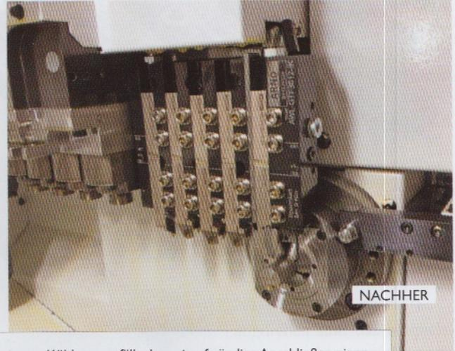
Durch die konstruktive Auslegung der Linearschlitten mit integrierter Kühlung entfällt das zeitaufwändige Anschließen einer externen und kostenintensiven Verschlauchung. Zudem entfallen Störkonturen im Maschinenraum. Ohne externe Verrohrung gibt es auch keine Flächen, an denen Späne anhaften und sich zu unliebsamen Störfaktoren aufbauen können.
