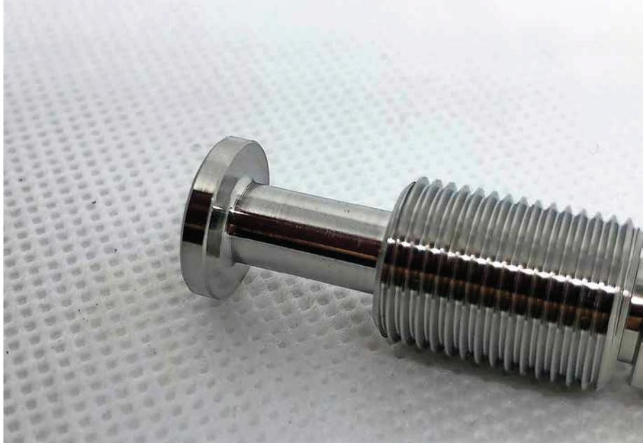
Für die Herstellung von Präzisionsdrehteilen aus Titan sind für dessen Bearbeitung abgestimmte Werkzeuge erforderlich. Weil die Späne beim Zerspanen von Titan nicht brechen, ist die richtige Werkzeugauswahl gerade zum Gewindedrehen besonders wichtig.
