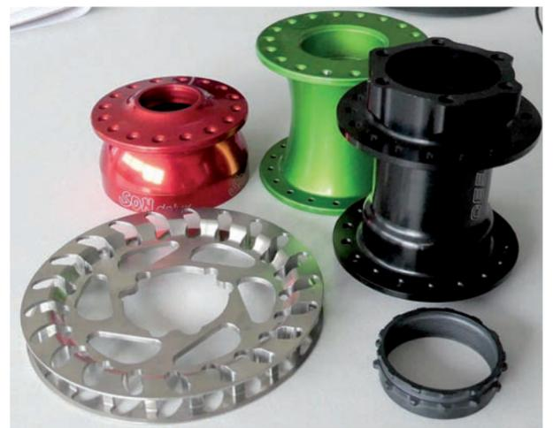
Die Ralf Weisheit GmbH fertigt unter anderem aus Aluminium Gehäuse für Nabenschaltungen und Nabendynamos von Hightech- oder Sonderfahrzeugen
