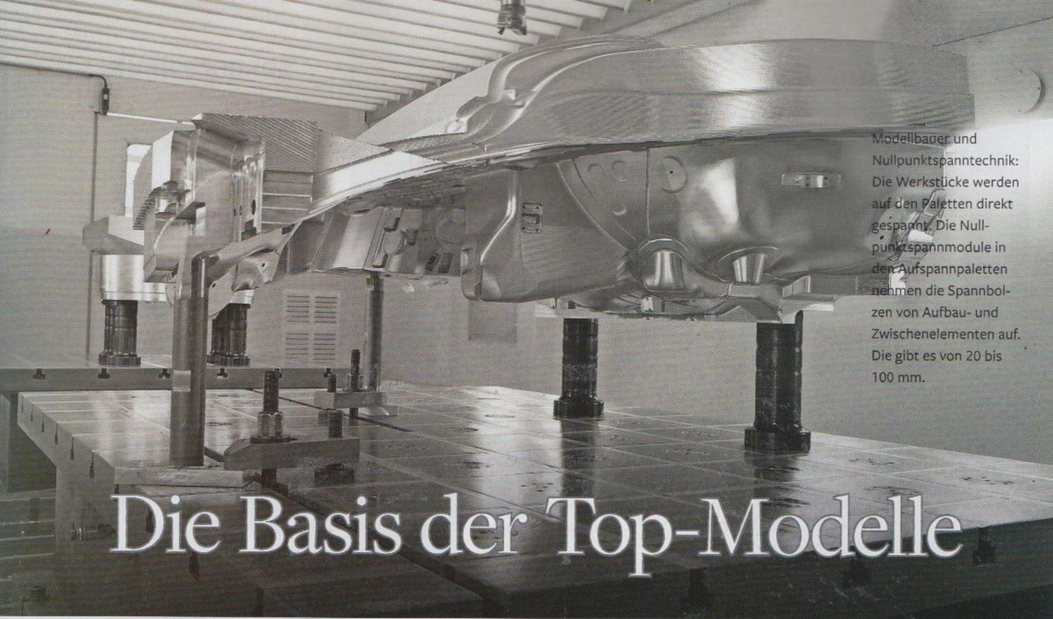
Modellbauer und Nullpunktspanntechnik: Die Werkstücke werden auf den Paletten direkt gespannt. Die Nullpunktspannmodule in den Aufspannpaletten nehmen die Spannbolzen von Aufbau- und Zwischenelementen auf. Die gibt es von 20 bis 100 mm.
