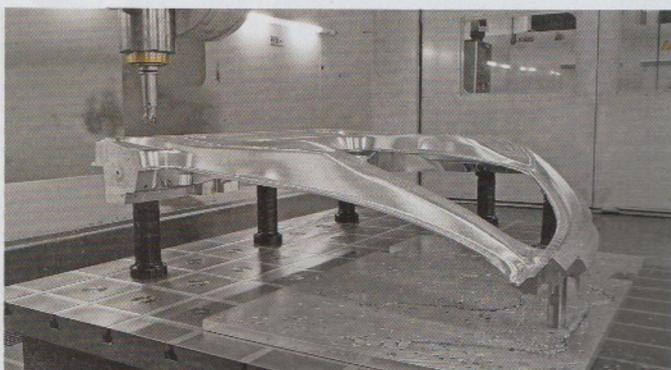
Karosserie-Seitenteil und Alufelgen werden aus dem Vollen zerspannt.
