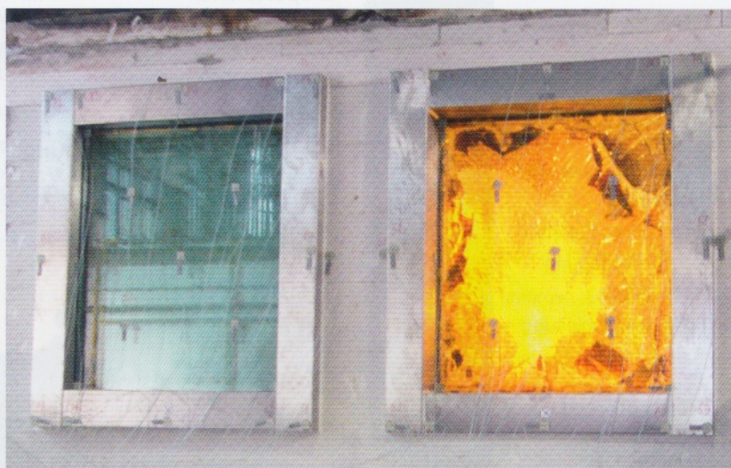
Brandtest: Als erster Hersteller weltweit präsentiert Walter Wurster eine F120-Fensterverglasung in Kombination mit FB6/BR4 und RC4.
