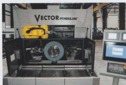
Bild 1 und 2: Durch zwei beidseitig zur Schleifscheibe angeordnete Werkstückspindeln ist man mit dieser Maschine in der Lage, zwei Prozesse in einer Maschine zu vereinen. Be- und Entladen erfolgt nahezu zykluszeitneutral und die Schleifscheibe pendelt zwischen den beiden Operationen
