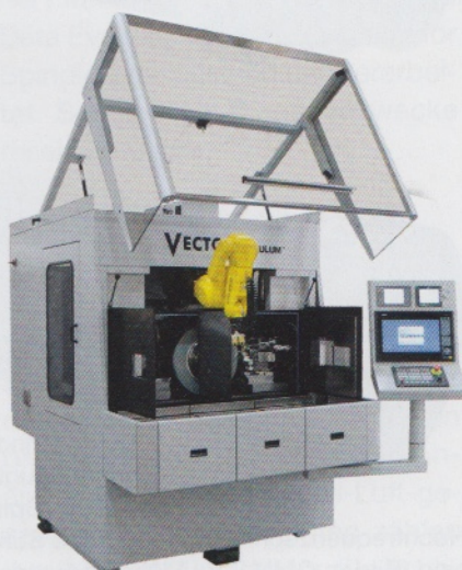
Bild 1 und 2: Durch zwei beidseitig zur Schleifscheibe angeordnete Werkstückspindeln ist man mit dieser Maschine in der Lage, zwei Prozesse in einer Maschine zu vereinen. Be- und Entladen erfolgt nahezu zykluszeitneutral und die Schleifscheibe pendelt zwischen den beiden Operationen
