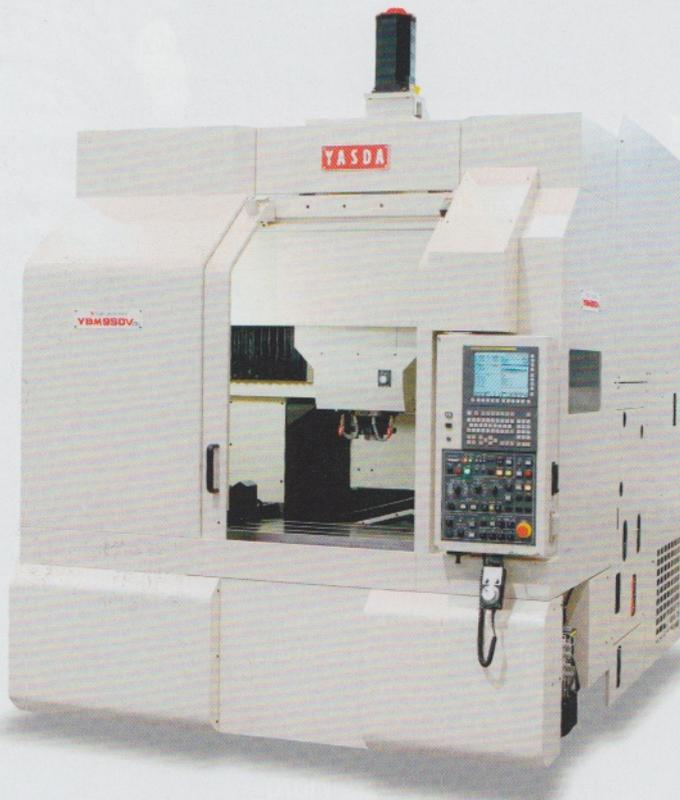
Bild 2: Die 3-Achs Fräsmaschine YASDA YBM 950V arbeitet mit prozesssicherer Präzision und der Qualität eines Lehrenbohrwerks (Werkbild: TECNO.team GmbH, Kirchentellinsfurt)
