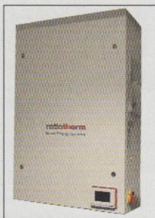
von bis zu 72°C. Die Heizleistung reicht von 3,1kW bis 8,7kW bei einer Leistungsaufnahme von 0,7kW bis 2,2kW. Der COP beträgt dabei mindestens 4,91. Das Aggregat lässt sich als Erd-, Grundwasser- oder in Kombination mit der Sole-Luft-Außeneinheit »WP Sat 15« als Luftwärmepumpe betreiben.
