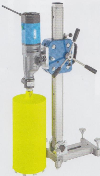
► Mit 2.200W Leistung, bis zu 940 Umdrehungen und bis zu 60nm Drehmoment erzeugt die BDB 8295 beim Kernbohren vibrationsarm maßgenaue Durchmesser von 42 bis 250mm
