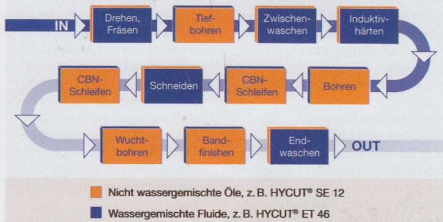
Das Blocklayout einer Kurbelwellen-Fertigungslinie zeigt die wechselnde Anwendung wassergemischter Fluide und nicht gemischter Öle aus einer Systemklasse des Oemeta-Produkts Hycut
