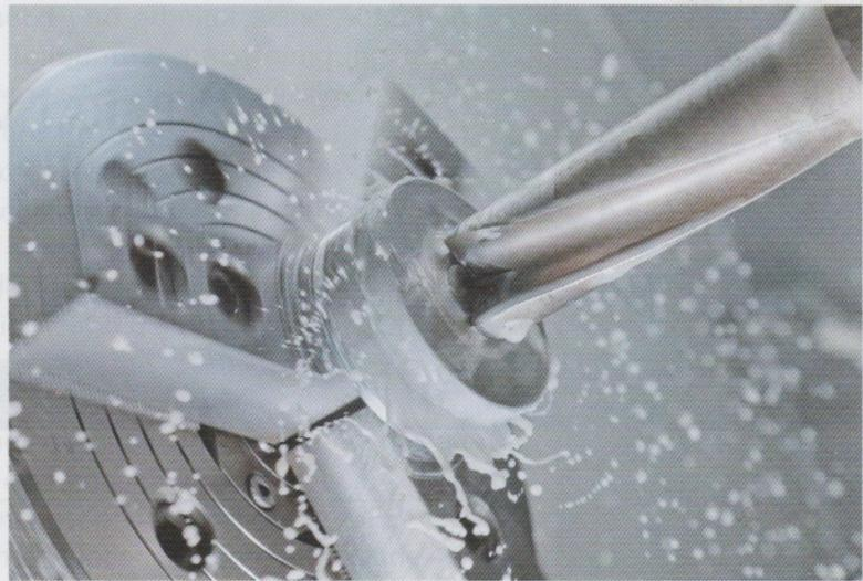
Titanlegierungen aus. Der kraftvolle und ausdauernde Kühlschmierstoff ist dabei frei von Mineralöl, Bor und Formaldehyd sowie Fungizid und Aktivschwefel. Dass er mit die Prozessqualität und Werkzeugstandzeit stark verbessert, konnte eine unabhängige Prüfstanz bestätigen.
