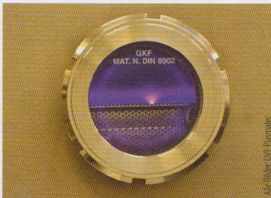
Die Plasma-Aktivierung sorgt dafür, dass sich freie Radikale mit den ausdiffundierenden nicht-elastomeren Stoffen verbinden und oxydieren.
