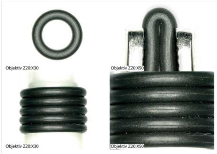
li.: Das auf zwei Jahre angelegte Projekt sieht monatliche Prüfungen der zurückgestellten Dichtungen vor. Hierfür liefert der Endkunde Prüfmittel und führt Prüfmittelüberwachungen durch.
