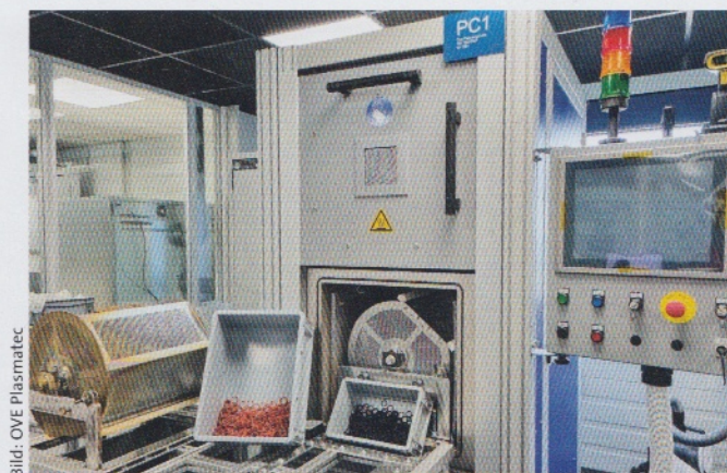
Im Technikum werden neuartige Beschichtungen im Plasma erzeugt.
