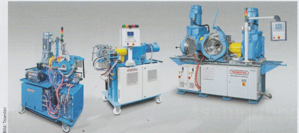
Zahnradextruder mit Durchsatzmengen von 275, 760 und 1.400 kg/h.
