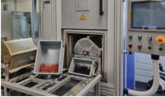
**MIT DER NEUEN PLASMABESCHICHTUNG** entstehen bei OVE Plasmatec beispielsweise hydrophile oder hydrophobe Oberflächen.
