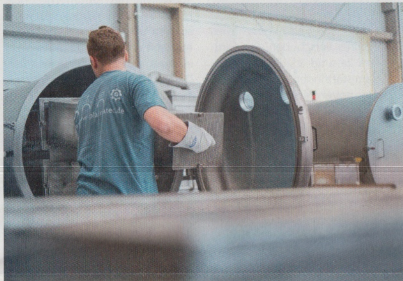
Durch die Plasmareinigung und -aktivierung in einer Niederdruckplasmaanlage erhöhen sich
