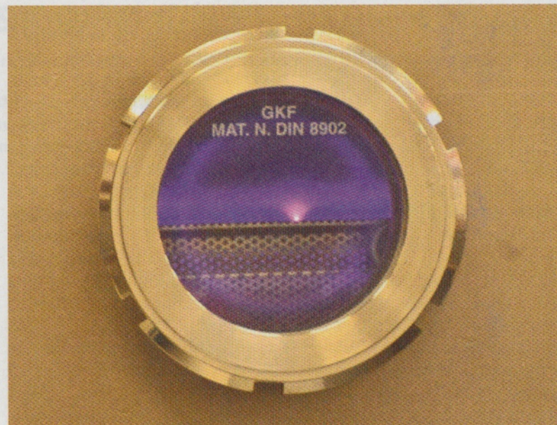
Die Plasma-Aktivierung sorgt dafür, dass sich freie Radikale mit den ausdiffundierenden, nicht elastomeren Stoffen verbinden und oxydieren. Bilder: OVE Plasmatec
