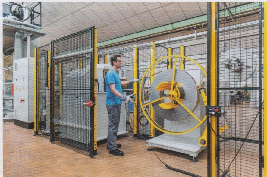
Bild 4: Eine Feinrichtmaschine entspannt das bis zu vier Millimeter starke und 300 mm breite Metallband ab Coil und ermöglicht die Fertigung von Bauteilen mit höchsten Ebenheitsanforderungen (Bilder: Nägeli Swiss AG)
