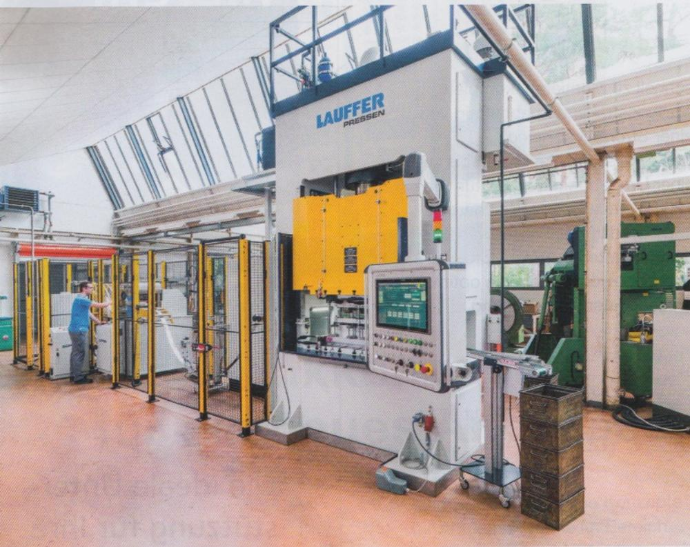
Bild 1: Nägeli Swiss AG tätigt die größte Maschineninvestition der Firmengeschichte und nimmt eine hydraulische 200-Tonnen Presse für die Fertigung von Tiefziehteilen in Betrieb
