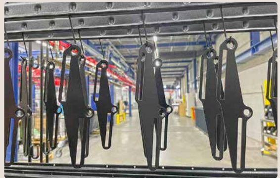
Ein KI-Tool prüft Teile vor der Pulverbeschichtung
