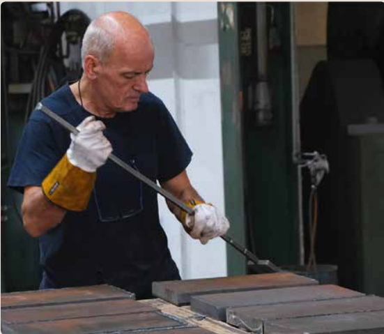
Teile werden nach dem Brennschneiden gesäubert
