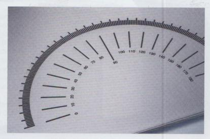
Zu den erweiterten auswählbaren Technologien gehören das präzise und hochauflösende Laserbeschriften zur Teilekennzeichnung wie Identifikationscodes, Seriennummern oder Logos (Bilder: © H.P. Kaysser)
