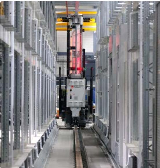
Gespeist werden die Maschinen im Kompetenzzentrum durch ein 52 Meter langes vollautomatisches Teilelager von Fastems
