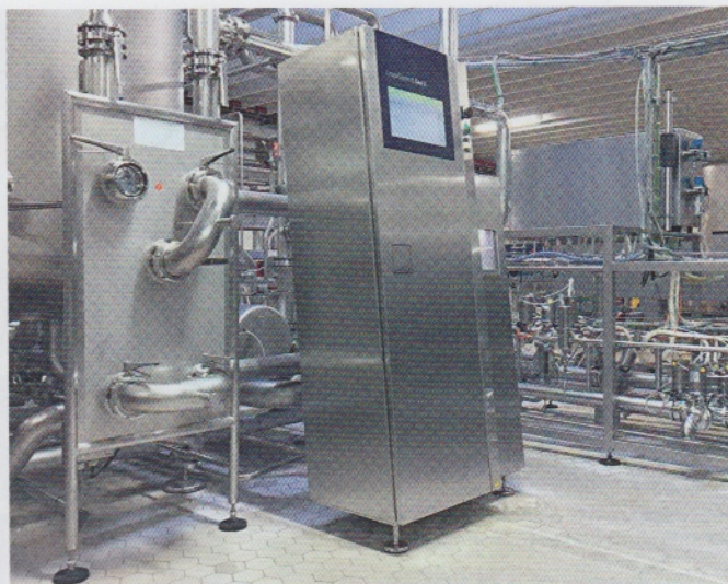
Auf dem von Hubl gefertigten Gehäuse können keine Flüssigkeiten stehen bleiben und der Bildschirm ist leichter abzulesen (Bild: Dausch).
