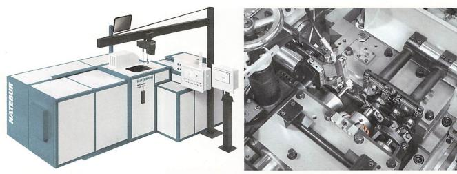
Schnell, flexibel, präzise: Auf der "HOTmatic AMP 20 N" lassen sich nahezu alle handelsüblichen Nockengrößen herstellen. Die Maschine ist leicht zugänglich und lässt sich problemlos einrichten.
