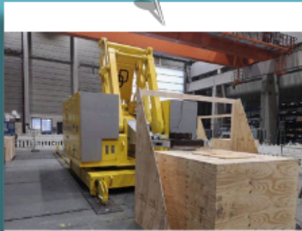
Der Schwerlastroboter legt die Werkstücke präzise im nachgebauten Ofen ab – gesteuert aus mehreren Tausend km Entfernung. Bild: Werksfoto Dango & Dienenthal Maschinenbau GmbH
