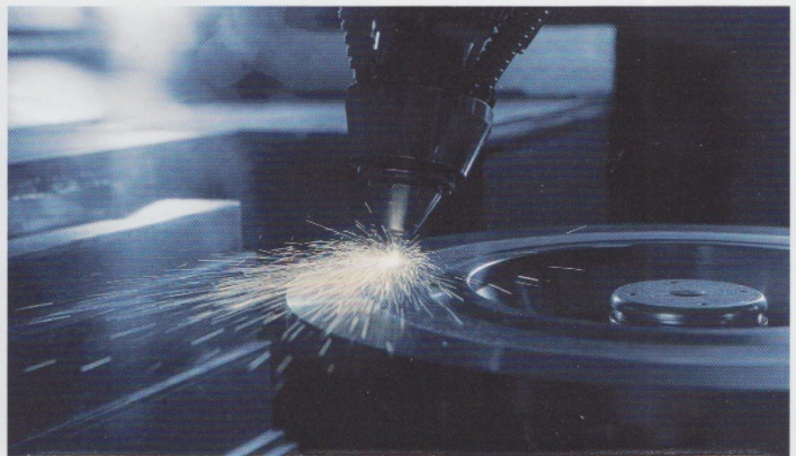
Die Hartstoffbeschichtung „Wecodur“ erfüllt die hohen Anforderungen der Automobilindustrie an die beschichteten Bremsscheiben. Foto: HPL Technologies
