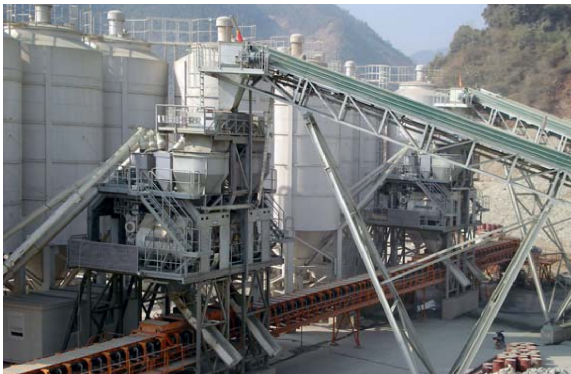
Betonmischanlage: Für anspruchsvolle Bauweisen werden immer öfter trockene und hochfeste Betonrezepte gefor- dert. Bilder: Liebherr
