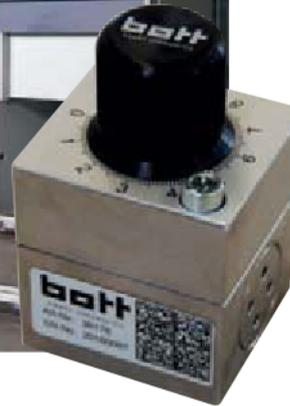
Für die Pressen verwendet der Hersteller zwei-Wege-Mikro-Stromregelventile von Bott. Dabei handelt es sich um einstellbare Drosselventile, die mithilfe einer Druckwaage den eingestellten Volumenstrom, unabhängig von der Druckdifferenz am Ventil, konstant halten.
