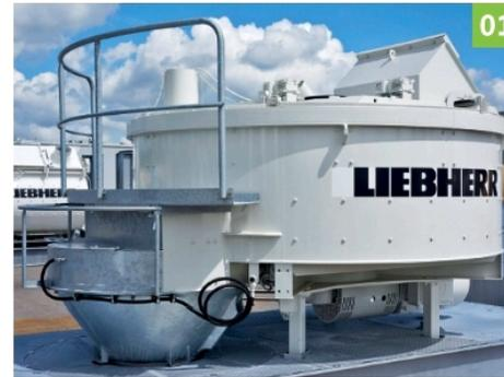
**01** Bis zu knapp vier Meter Durchmesser und drei Kubikmeter Füllmenge groß sind die aktuellen Liebherr-Ringtellermischer
