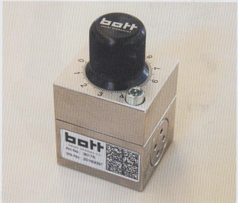
Das von Bött entwickelte 2-Wege Mikro-Stromregelventil ist ein einstellbares Drosselventil, das mithilfe einer Druckwaage den eingestellten Volumenstrom konstant hält.
