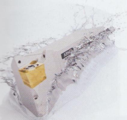
Drei präzise ausgerichtete Kanäle leiten das Kühlmittel von oben und von unten genau an die Schneide, ohne den Spanabfluss zu behindern. Durch die besondere Geometrie des Kühlkanals entsteht ein Düsen-Effekt mit stark verbesserter Kühlwirkung.
