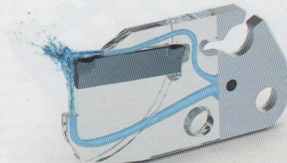
Durch das Additive Verfahren gelingt es, beim patentierten ACS von ARNO strömungsoptimierte Kanäle in den Werkzeughalter einzubringen und das Kühlmittel exakt zu positionieren.
