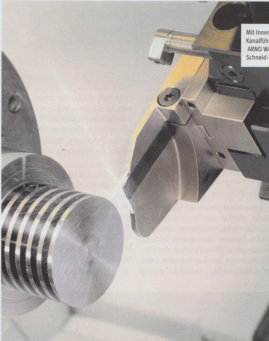
Mit Innenkühlung durch clevere und hochfeine Kanalführungen gelingt es Werkzeugherstellern wie ARNO Werkzeuge, den Kühlschmierstoff direkt in die Schneid- und damit in die Problemzone zu führen.
