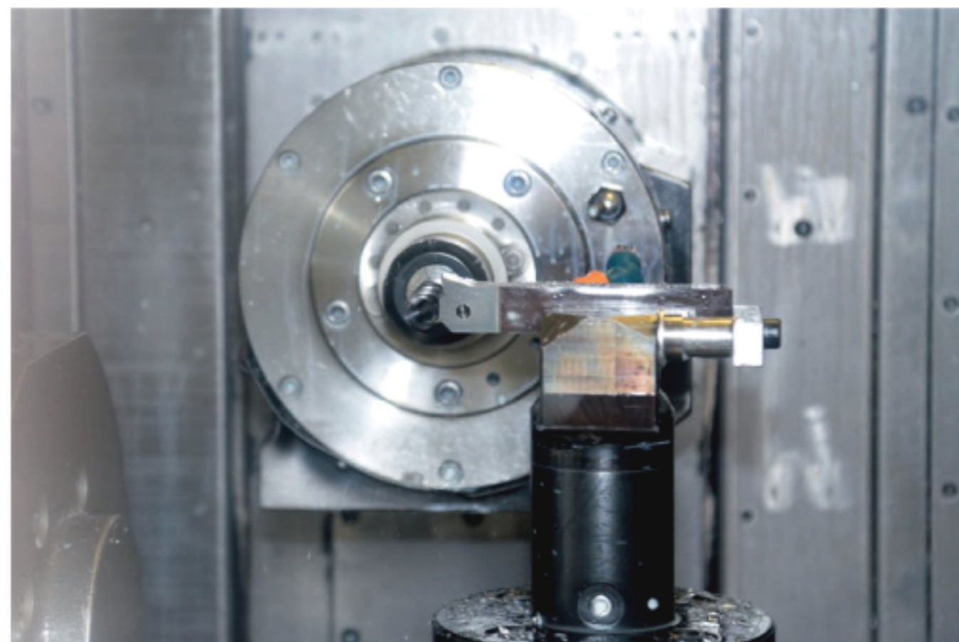
Der Werkzeugkopf wird auf einem Bearbeitungszentrum zerspanend nachbearbeitet, um die finale Werkzeuggeometrie zu erstellen.
