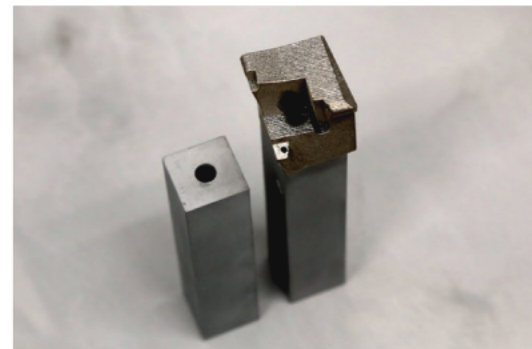
Auf einen Grundkörper aus vorvergütetem Stahl wird mit 1.2709-Pulver der Werkzeugkopf aufgebracht. Kühlmittelkanäle können dabei nahezu frei definiert werden. (Bild: x-technik)
