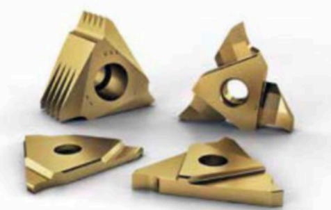
Die neuen dreischneidigen Stechplatten TE09 und TE14 gibt es für das Ein- und Abstechen bis zu einer Stechtiefe von vier beziehungsweise 6,5 mm und Einstechbreiten von 0,5 - 6 mm.
