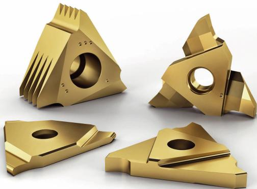
5 Bei ATS lassen sich mit Profilstechplatten bis zu 20 mm lange Konturen auf einer Platte spiegeln. Varianten mit umfanggeschliffenen, scharfen Schneiden sind ideal für die Arbeit mit wenig Schnittdruck bei filigranen und dünnwandigen Teilen © Arno
