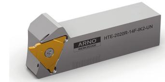
3 Bei diesem Halter des dreischneidigen ATS-Werkzeugsystems zum präzisen Abstechen von kleinen Bauteilen stellt eine versenkte Klemmschraube die stabile, genaue Klemmung an der geschliffenen Anlagefläche sicher © Arno
