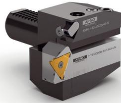
4 Das ATS-System, zu dem auch dieser Halter gehört, ermöglicht eine im Verhältnis zum geringen Baumaß relativ große Stechtiefe von 6,5 mm. Die Einstechbreite beginnt bei sehr schmalen 0,8 mm und reicht bis 6 mm © Arno
