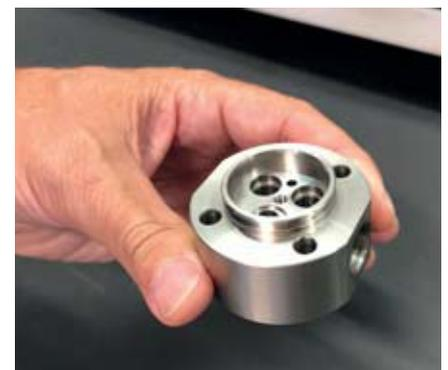
Die Injektoren, die Suttner mit Unterstützung von Arno Werkzeuge fertigt, bestehen aus drei Teilen mit insgesamt etwa 30 Bauteilen.
