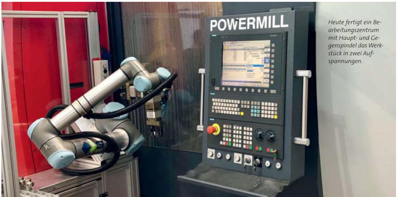
Heute fertigt ein Bearbeitungszentrum mit Haupt- und Gegenspindel das Werkstück in zwei Aufspannungen.
