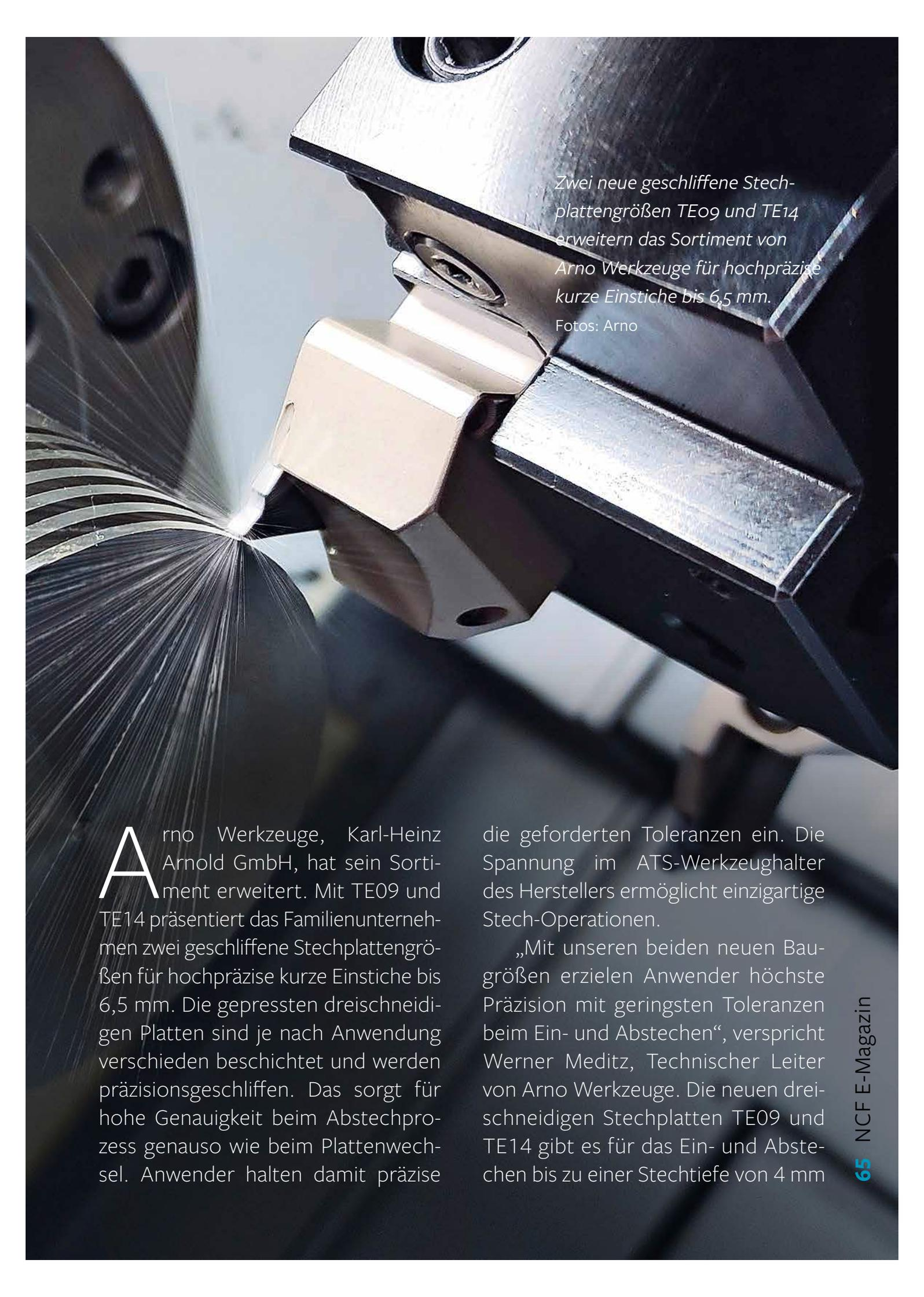
Zwei neue geschliffene Stechplattengrößen TE09 und TE14 erweitern das Sortiment von Arno Werkzeuge für hochpräzise kurze Einstiche bis 6,5 mm.
