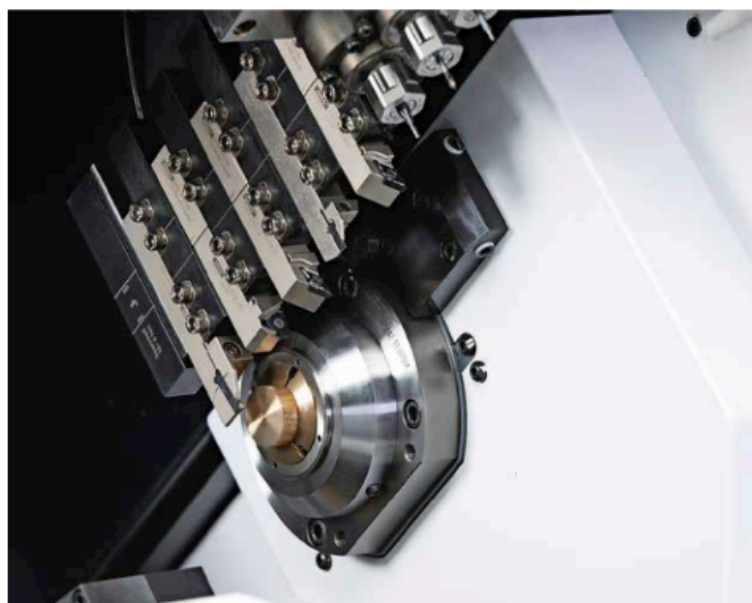
Das patentierte Werkzeugaufnahmesystem AWL-Linear Schlitten von Arno Werkzeuge unterstützt Komplettbearbeitung in Zeiten des Fachkräftemangels.
