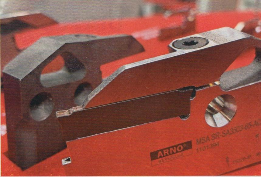
Besonders langlebig sind die von Arno Werkzeuge additiv hergestellten ACS2-Stechwerkzeuge, die über optimal angeordnete und dreieckige Kühlkanäle verfügen, wie unten links zu sehen ist.
