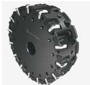
zur Aluminiumbearbeitung. Der speziell für den Hochgeschwindigkeitseinsatz konzipierte Fräser eignet sich zum Aluminium-Schlichten und -Schruppen (ap bis 10 mm) genauso wie zum Schmierfräsen (zum Beispiel von Motorblöcken aus Aluminiumguss) und zum Schlichten von Bauteilen aus Bimetall. Durch die geschlossene Oberfläche und die austauschbaren Spanabweiser werden die Späne über die Seite, vom Bauteil weg, abgeführt, was die Anzahl der Späne am Bauteil senkt.
