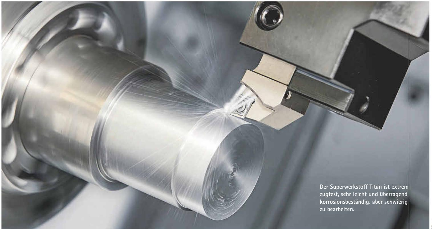
Der Superwerkstoff Titan ist extrem zugfest, sehr leicht und überragend korrosionsbeständig, aber schwierig zu bearbeiten.
