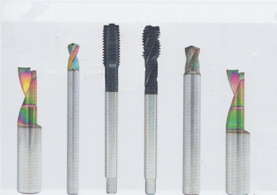
Desert Cut®-Werkzeuge von ARNO Werkzeuge wurden speziell auf die Trockenbearbeitung von Aluminiumprofilen ausgerichtet. So erzielen Anwender bei Bohr-, Fräs- und Sägeoperationen in der Trockenbearbeitung von blankem und eloxiertem Aluminium nahezu gratarme Ergebnisse mit einer hohen Oberflächengüte
