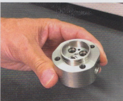
Bild 2: Die Injektoren, die Suttner mit Unterstützung von ARNO Werkzeuge fertigt, bestehen aus drei Teilen mit insgesamt etwa 30 Bauteilen
