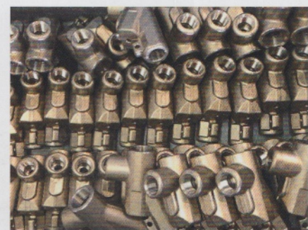
Bild 4: Ventilgehäuse aus geschmiedetem Edelstahl für professionelle Hochdruckreiniger, wie sie beispielsweise in Fleischfabriken für die nächtliche Reinigung verwendet werden
