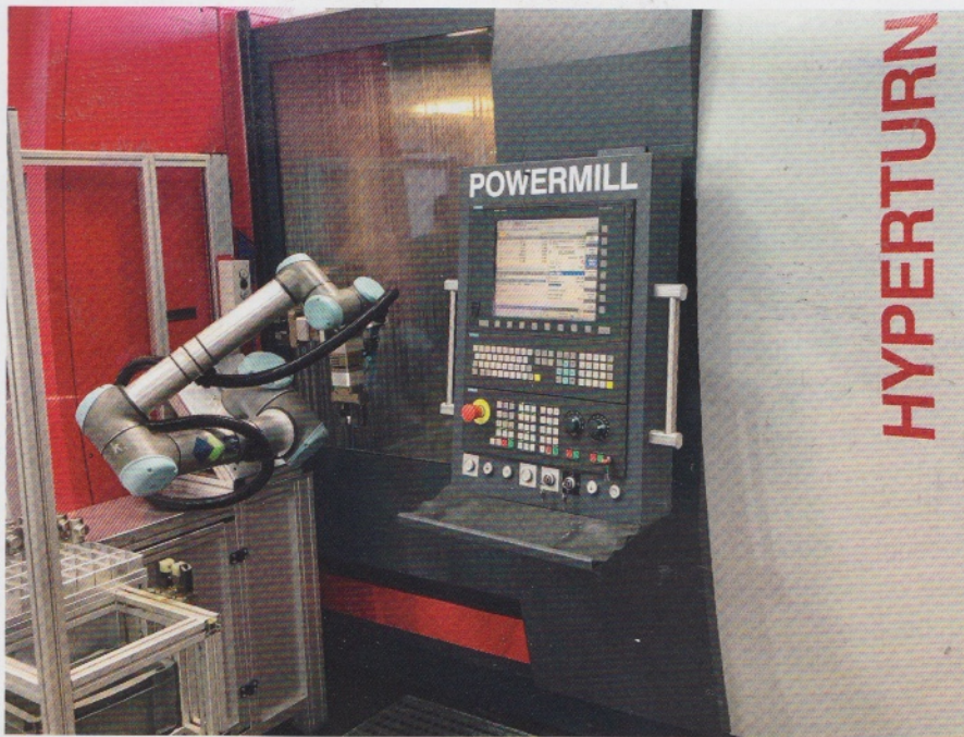
Bild 6: Das Ventilgehäuse wurde früher auf vier Maschinen mit ebenso vielen Aufspannungen bearbeitet. Heute fertigt ein Bearbeitungszentrum mit Haupt- und Gegenspindel das Werkstück in zwei Aufspannungen in einem Bruchteil der früheren Zeit. Und mit Beladeroboter läuft der gesamte Prozess vollautomatisch ab
