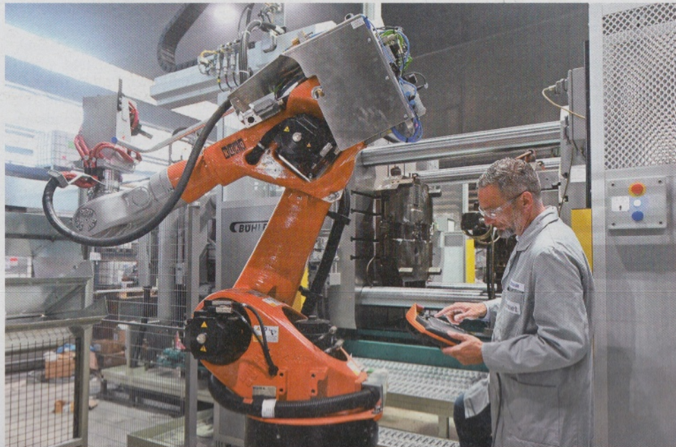
Produktion von Druckgusskomponenten aus Aluminium für den Fahrzeugbau bei Bohai Trimet Automotive
