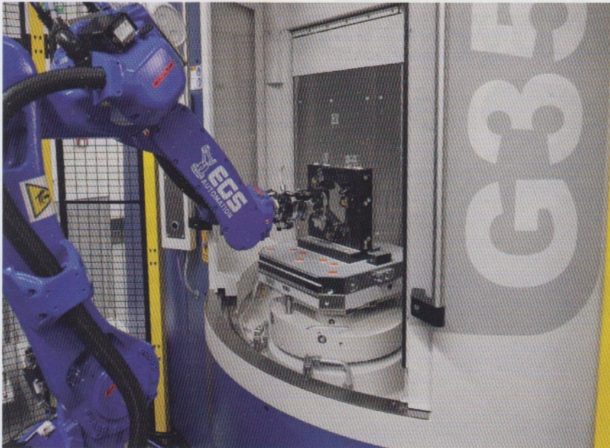
Der Deckel wird senkrecht in die bogenförmige AMF-Vorrichtung eingebracht, die ihn an den schmalen Seiten komplett umschließt.
