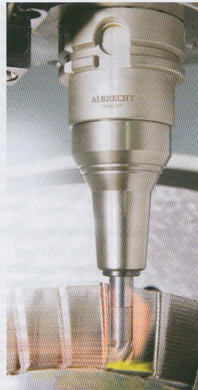
Mit dem Slim5 Präzisions-Spannfutter von Albrecht können Werkzeuge an schwer zugänglichen Stellen gerade bei 5-Achsapplikationen sicher und zuverlässig gespannt werden.
